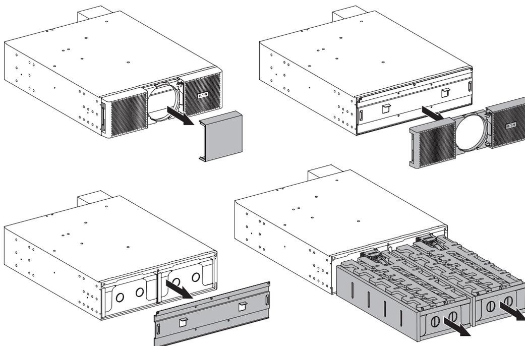
4. Tirez sur la poignée en plastique à gauche et à droite des batteries puis faites-les glisser avec précaution sur une surface plate et stable. Soutenez les batteries avec les deux mains. Laissez-les de côté pour les réinstaller lorsque l'EBM sera installé dans le rack.
