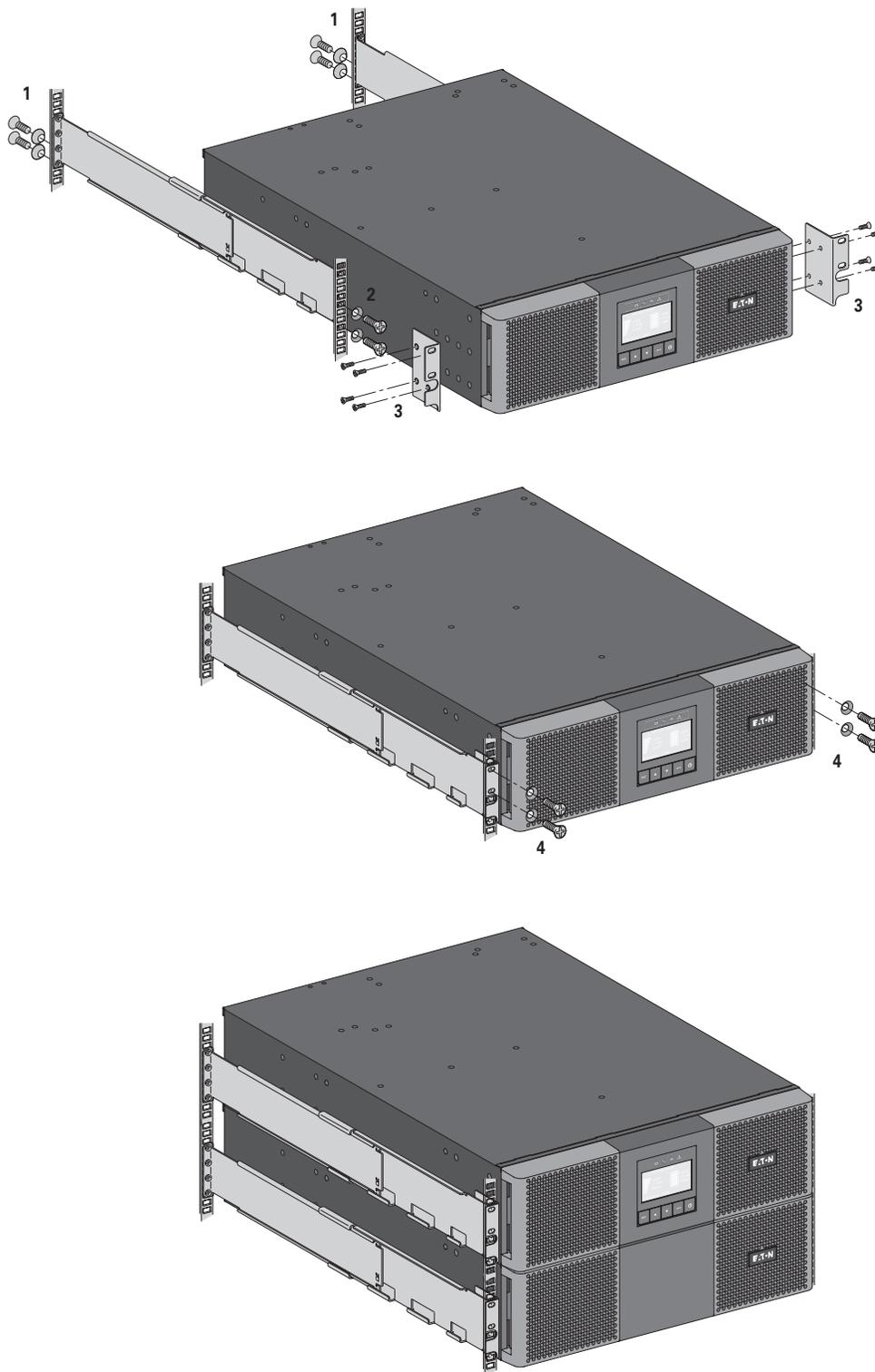
Les rails et le nécessaire de montage sont fournis par EATON (en option).
